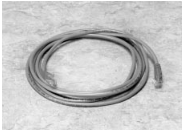
写真 1.4 LAN ケーブル
